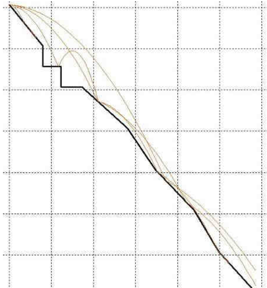
Fig. 57 – Traiettoria di caduta di un masso di 100 KN a diverse velocità di distacco nel profilo 4.
