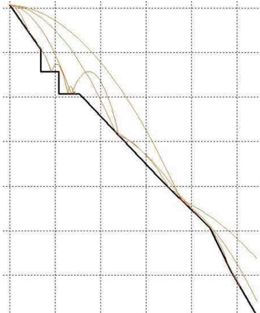
Fig. 55 – Traiettoria di caduta di un masso di 100 kN a diverse velocità di distacco nel profilo 2.
