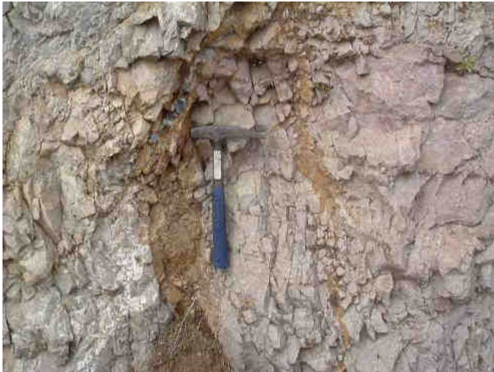
Fig. 4 - Particolare della parete rocciosa costituita da dolomie, si notano vene di calcite.
